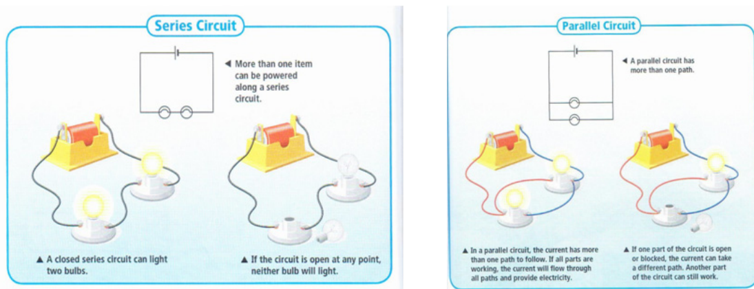
그림 5. 미국 초등학교 교과서에 나타난 전구의 직렬연결과 병렬연결에서 전구를 뺏을 때 전류가 흐르는지 판단하여 닫힌회로에 대한 개념을 형성하는 그림.
