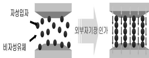
그림 8. 자기 유변 유체의 원리를 나타내는 모식도.
