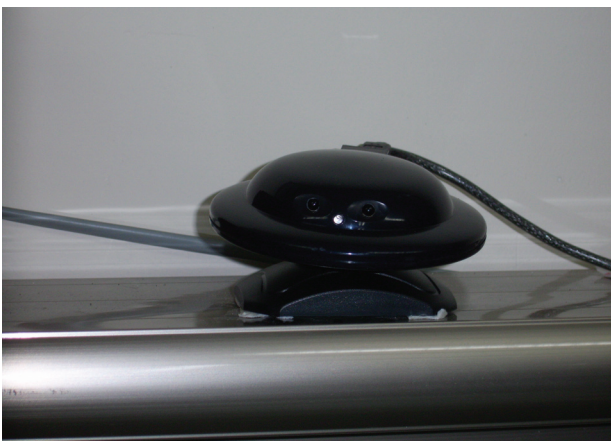
그림 2. 컴퓨터에 연결된 수신 장치로 학생들이 전송한 답을 수신하는 기능을 가지고 있다. 이 수신기 내에는 35개의 서로 다른 채널이 있어 학생들이 개별적으로 전송한 답을 혼선없이 교사의 컴퓨터로 보내게 된다.
