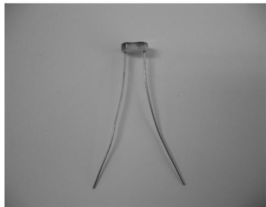
그림 2. CdS photoresistor.
