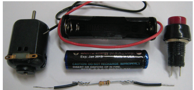
전동기(1.5V ~ 3V용, 사각형), AAA 전지 1개, AAA 전지홀더(1구), 버튼스위치(On-Off, Lock), 저항 0.5Ω
