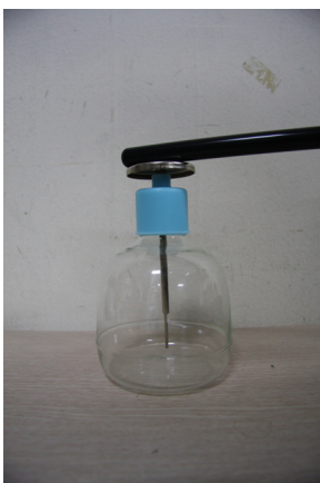
그림 8. 대전체 접촉시키기-금속박이 벌어진다.
