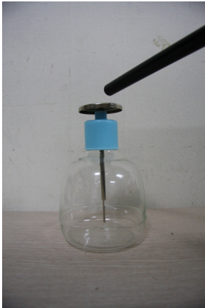
그림 6. 대전체를 좀 더 가까이 금속박이 더 많이 벌어진다.
