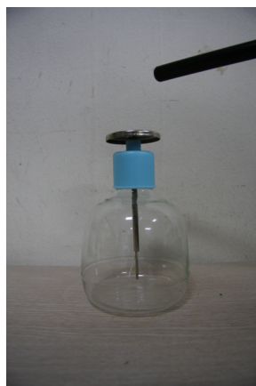
그림 10. (-)대전체 다시 가까이하기-금속박이 오므라든다.
