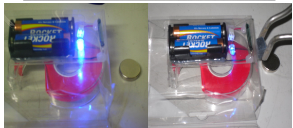
그림 4. 리드스위치 이용한 자기장 차폐장치.
