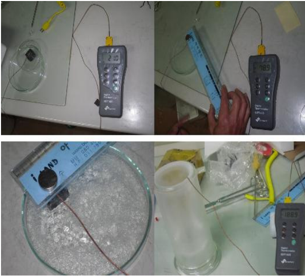
그림 2. 마이스너 현상을 이용한 임계온도측정.
